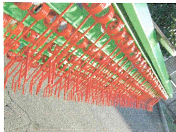
Particolare denti a molla versione piegata o dritta
